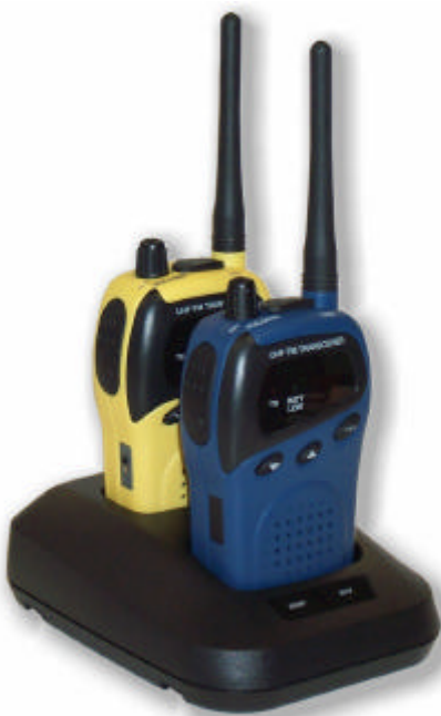
Caricatore doppio da tavolo dedicato: INTEK DDC-230 (Utilizzabile esclusivamente con i pacchi BPH-230D e BPH-230M)
